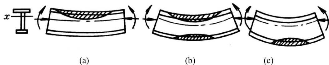
图 4.1.9 单轴对称压弯构件失稳时可能的塑性区分布
